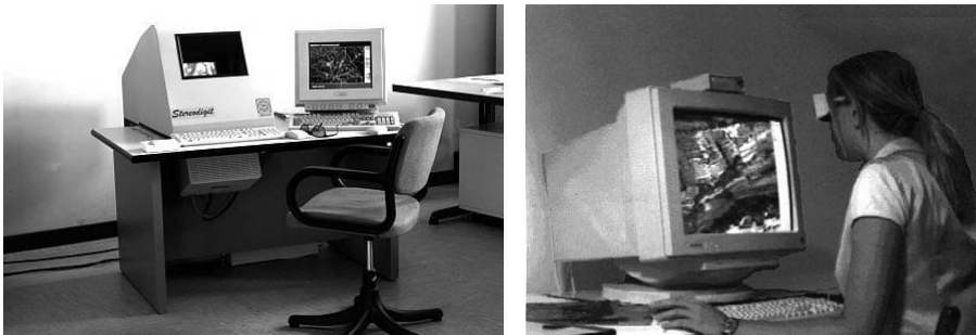
fig.01 – stereorestitutore digitale stereodigit a visione passiva e stereorestitutore digitale con operatore munito di occhiali a polarizzazione attiva.
